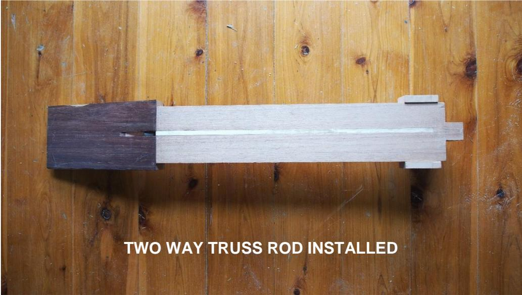
TWO WAY TRUSS ROD INSTALLED
