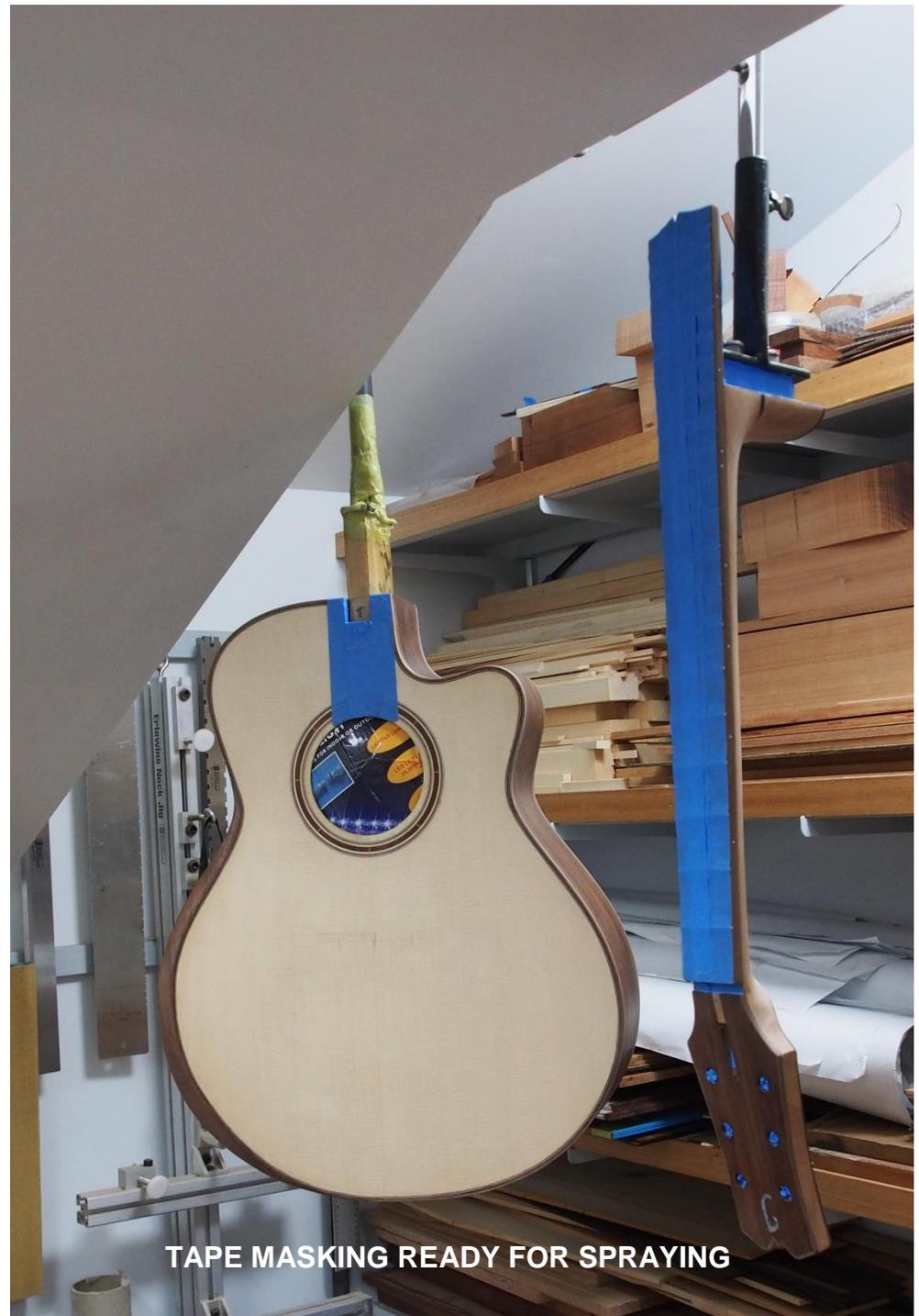
TAPE MASKING READY FOR SPRAYING
